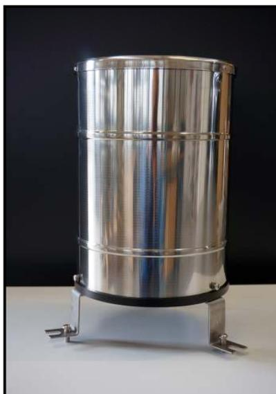
Sensore a vaschetta basculante per la misura della quantità di precipitazione con uscita standard. Lo strumento è composto da un cono di raccolta e da una vaschetta basculante che genera un impulso equivalente a 0,2 mm di precipitazione. Questo sensore è il prodotto consumer adatto per applicazioni non gravose.
