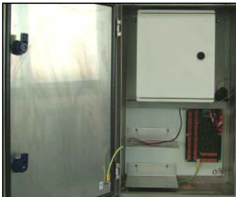
Foto indicativa elettronica in doppio contenitore grande: acciaio inox - piccolo: poliestere
